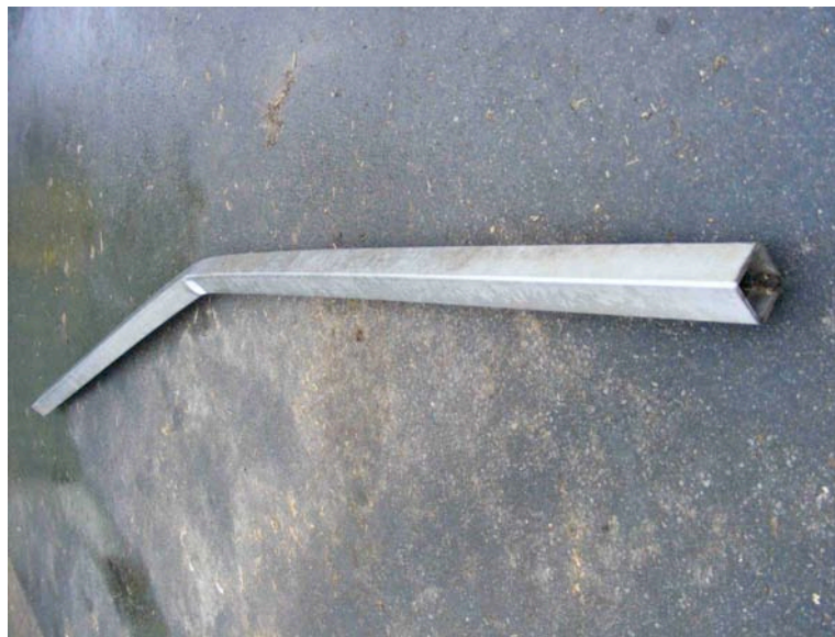
Abb. 3: Vom Gärgut im Fermenter eingedrückter Rührwerksmast.
